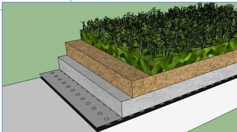
VMH30 Opbygningshøjde: 100-120mm Maks. vægt: ca. 75-125kg/kvm Vandtilbageholdelse: ca. 50-70ltr/kvm
